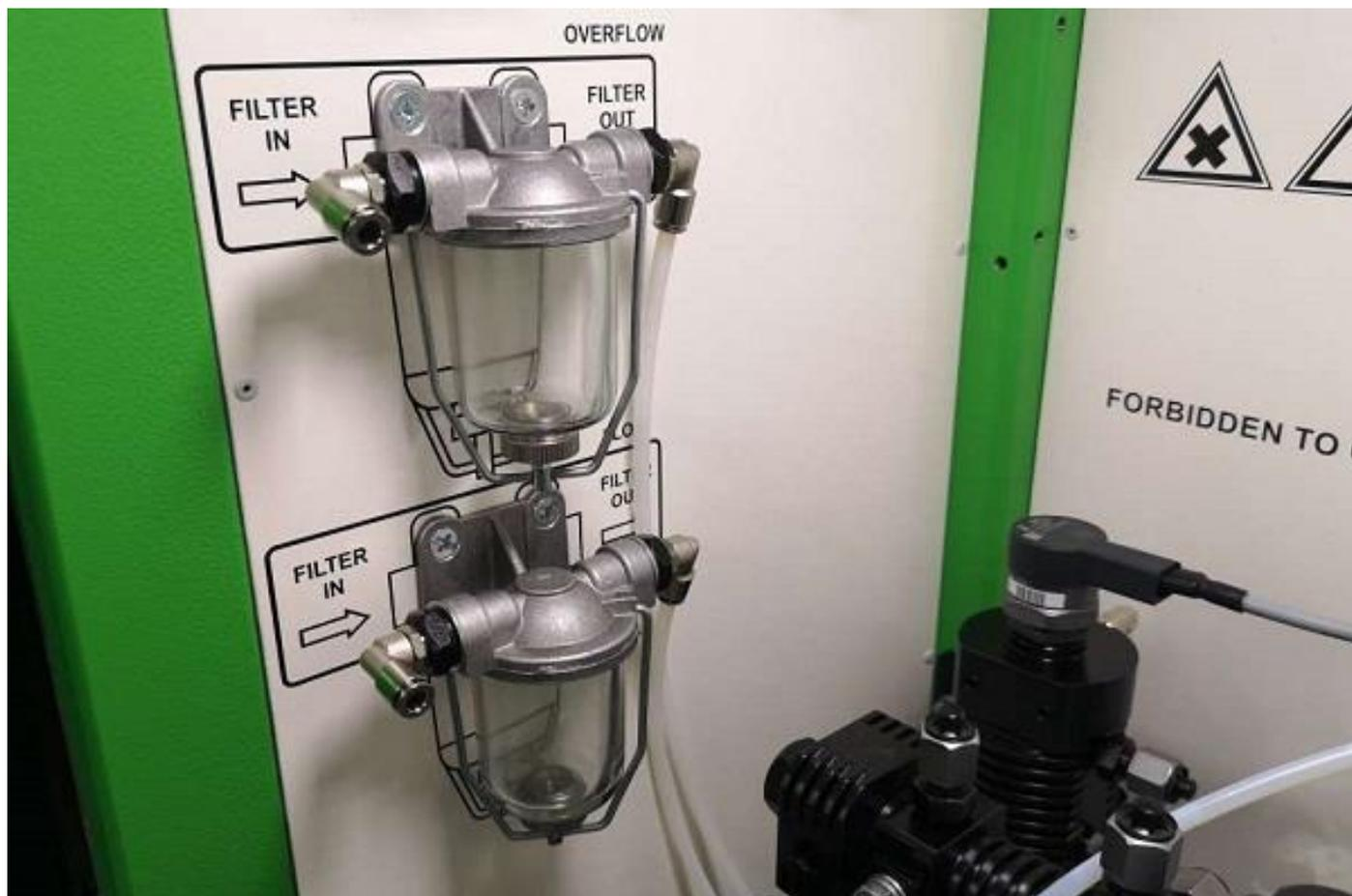
Предназначены для предварительной очистки форсунок перед их проверкой на стенде.
